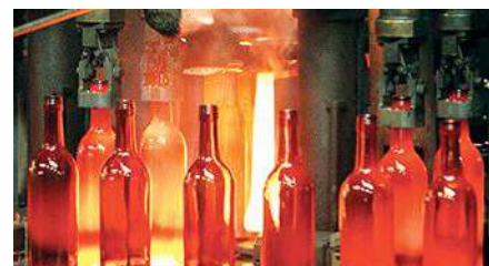
2. Fabrication des bouteilles en verre dans des fours à température constante et permanente de 1500 °C
